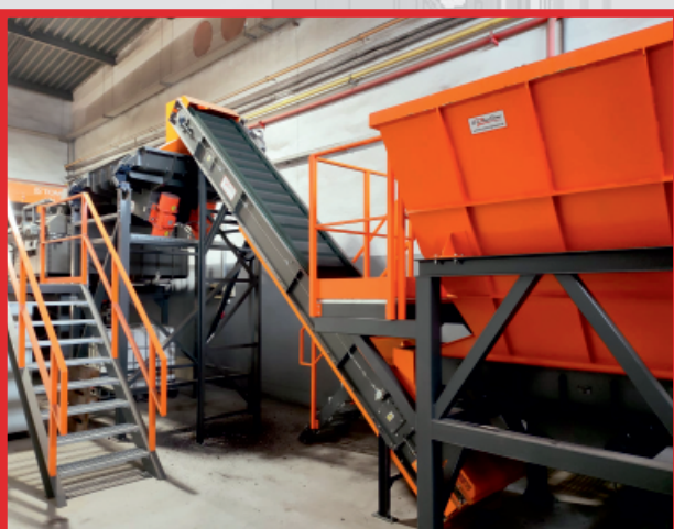
Linia technologiczna do dozowania rozdrobnionej frakcji WEEE
