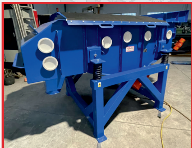
Przesiewacz wibracyjny dwupokładowy do granulatów
