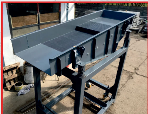
Podajnik wibracyjny odsiewający tworzywa sztuczne
