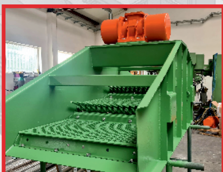
Przesiewacz wibracyjny z siem rusztowym do odpadów komunalnych
