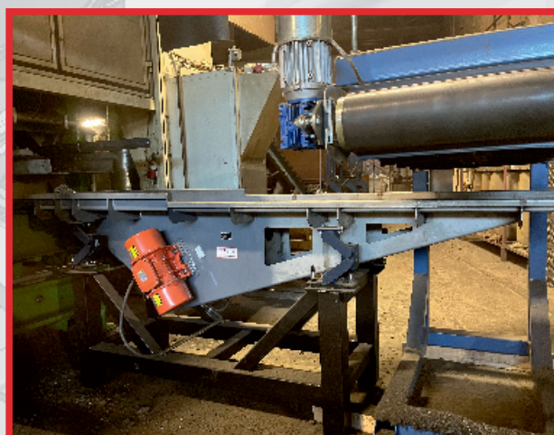
Podajnik wibracyjny z separatorem magnetycznym
