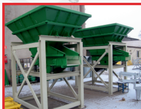
Stacja dozowania surowców na napędzie elektromagnetycznym
