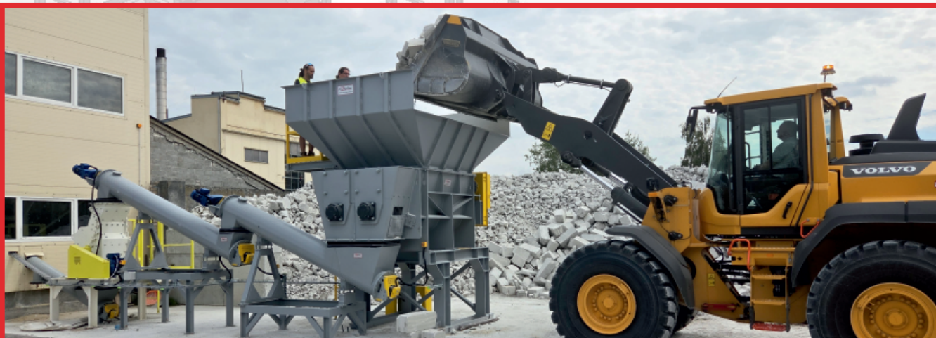
Linia technologiczna do pełnego odzysku bloczków z betonu komórkowego i materiałów budowlanych
